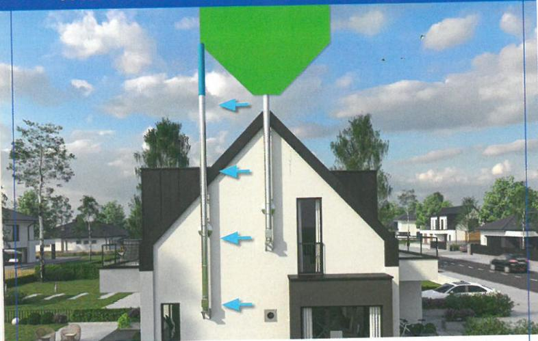
Die neuen Ableitbedingungen § 19 1. BImSchV reduzieren die Installationsmöglichkeiten für mit Festbrennstoffen betriebene Schornsteine.
